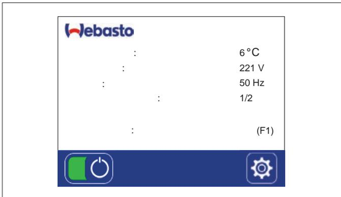
**Рис. 19** Пример стартового экрана чиллера без регулирования температуры в каюте
