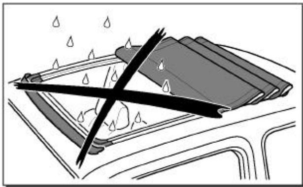
Bei Geschwindigkeiten über 120 km/h darf das Schiebedach nicht betätigt werden.
