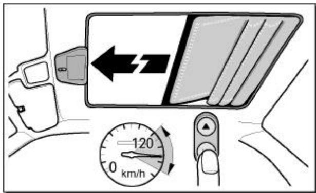
Bei Temperaturen unter Null Grad Celsius darf das Schiebedach nicht betätigt werden.
