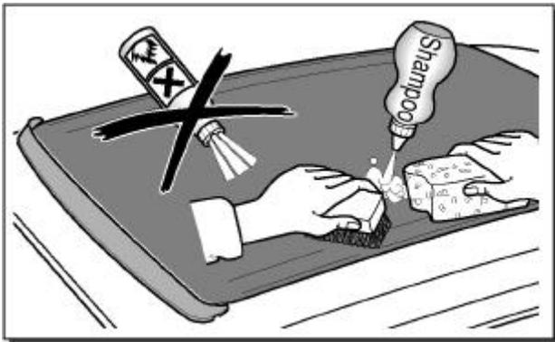
Das Äußere des Schiebedachs mit einem milden Reinigungsmittel säubern.
