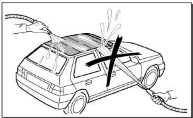
Die Oberseite des Schiebedachs mit einem Wasserschlauch abspritzen.
