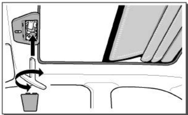
...das Schiebedach mit dem Notschlüssel schließen.
