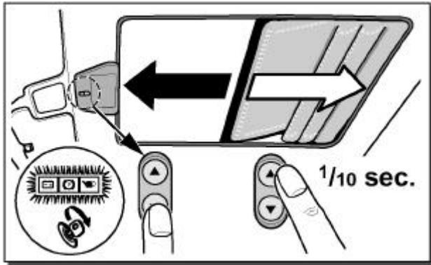
Das Schiebedach durch kurzes Antippen der Taste schließen.
