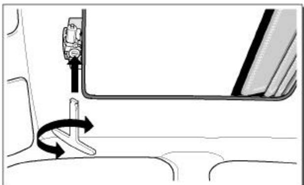
...und das Schiebedach mit dem Notschlüssel schließen.
