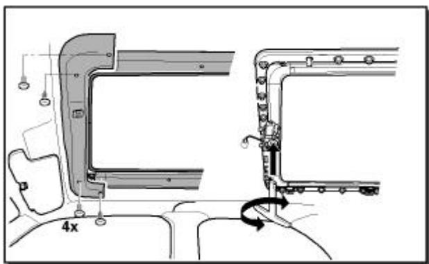
Die Verkleidung entfernen und das Schiebedach mit dem Notschlüssel schließen.
