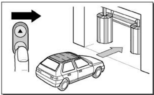
Das Schiebedach vollständig schließen...
