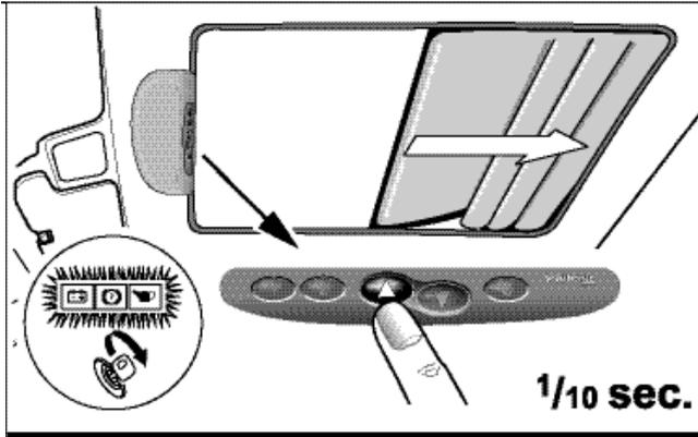
Das Schiebedach durch kurzes Antippen der Taste öffnen.
