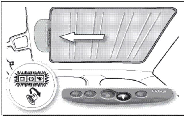
Das Stoffverdeck mit der "Schließen"-Taste vollständig schließen, bis ein Klicken hörbar wird.
