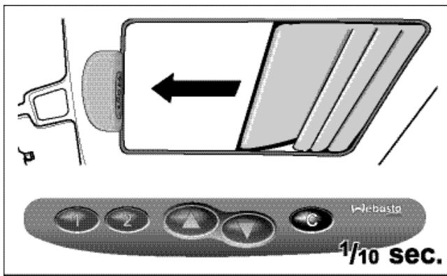
Bei Betätigung von Taste "C" wird das Schiebedach vollständig geschlossen.
