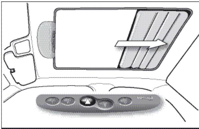
Das Stoffverdeck mit der "Öffnen"-Taste vollständig öffnen, bis ein Klicken hörbar wird.
