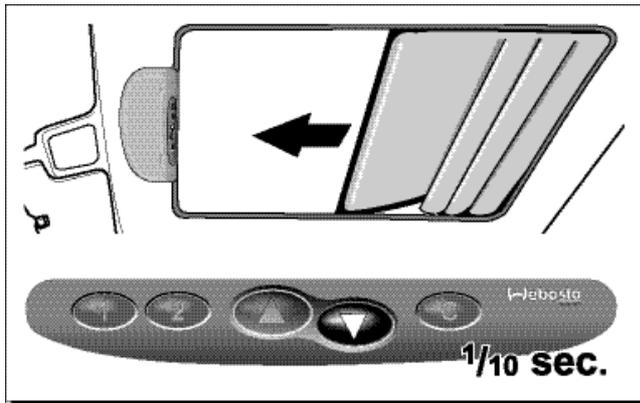
Das Schiebedach durch kurzes Antippen der Taste schließen.
