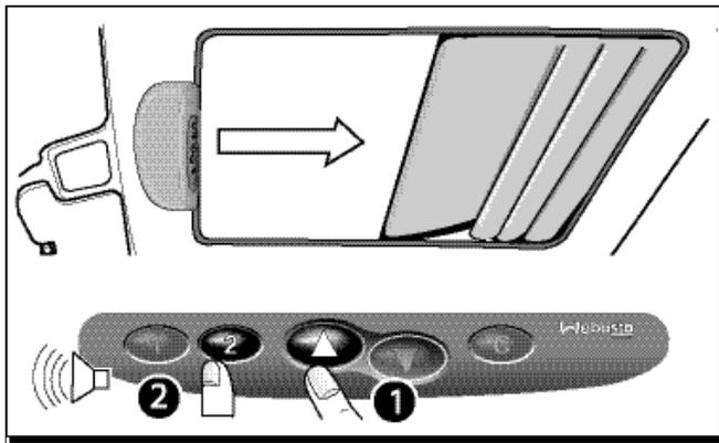
Die Öffnungstaste betätigen, bis die zweite zu programmierende Position erreicht ist.
