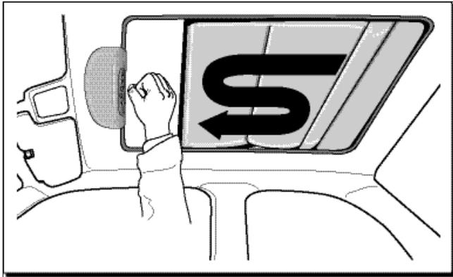
Wenn das sich schließende Schiebedach auf ein Hindernis stößt, öffnet es sich automatisch. Nach Entfernen des Hindernisses schließt sich das Schiebedach automatisch.
