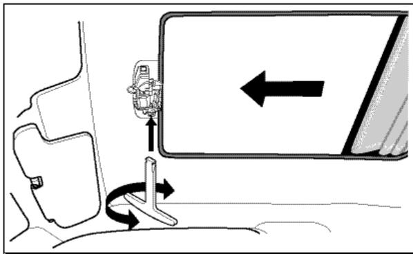
Das Schiebedach mit dem Notschlüssel schließen.
