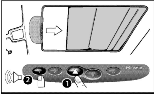
Die Öffnungstaste betätigen, bis die erste zu programmierende Position erreicht ist.
