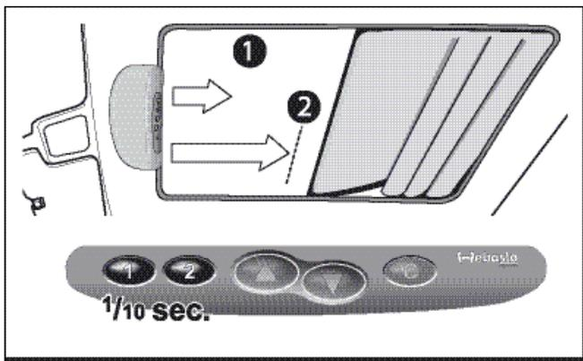
Das Schiebedach kann nun durch einen Druck auf Taste "1" bzw. Taste "2" automatisch bis zur programmierten Position geöffnet werden.
