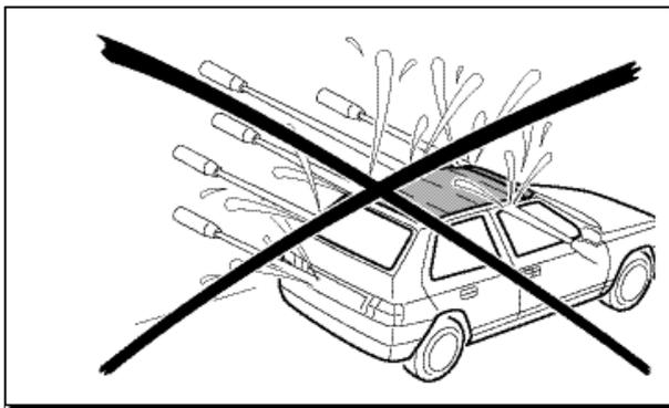
Das Dach keinem starken Wasserstrahl aussetzen.
