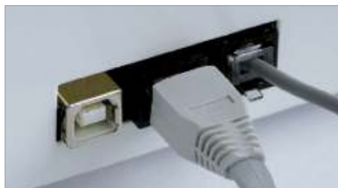
Подключение датчика температуры, дисплея и диагностики происходит снаружи блока управления
